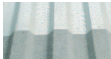
Plåt med Constop suger upp fukten, på obehandlad plåt bildas kondens.
